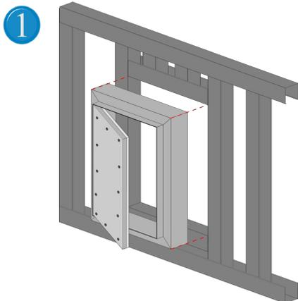
1 Setzen Sie die Ständerprofile der Unterkonstruktion passgenau beidseitig der Laibung ein. Diese sollten aus mind. 2 mm starken U-Stahlprofilen bestehen und vom Geschossboden bis zur Geschossdecke durchgehen.
