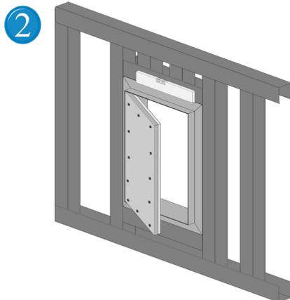
2 Bringen Sie die Jumbotür so ein, dass eine anschließende flächenbündige Beplankung gewährleistet ist. (Im Falle eines nachträglichen Einbaus ist auf einen Gipsüberstand von mind. 30 mm zu achten, damit der Rahmen der Jumbotür eingefügt und angeschraubt werden kann.)
