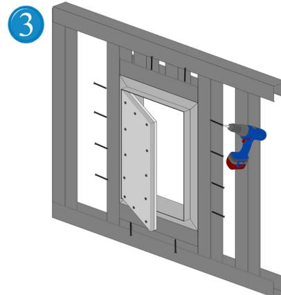
3 Verschrauben Sie die U-Profile der Ständerwand ausreichend mit dem Einbaurahmen der Jumbotür.
