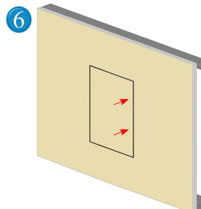
6 Durch gleichmäßiges Drücken am Türblatt auf der Seite der Schnappverschlüsse können Sie die Jumbotür öffnen und schließen.
