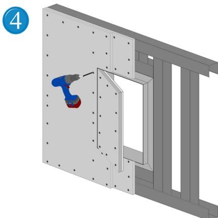
4 Bei der anschließenden Beplankung können Sie die Gipskarton-Platten direkt am Einbaurahmen der Jumbotür verschrauben.
