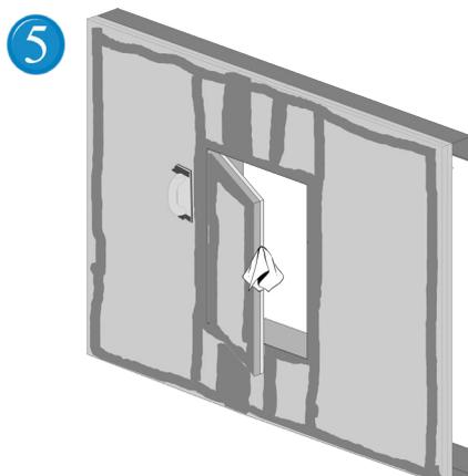
5 Verspachteln Sie umlaufend die eingebaute Revisionsklappe inkl. Türblatt. Schleifen Sie nach dem Trocknen alle Unebenheiten ab. Entfernen Sie sorgfältig jegliche Verschmutzungen an Einbaurahmen und Türblatt der Revisionsklappe. Dadurch verhindern Sie, dass die Funktion der Revisionsklappe beeinträchtigt wird. (Auch bei anschließenden Malerarbeiten müssen Einbaurahmen und Türblatt der Revisionsklappe sorgfältig gereinigt werden!)
