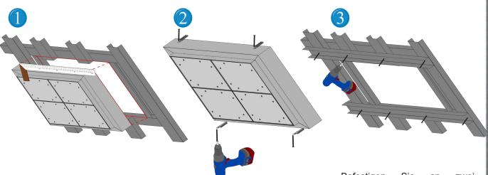
Prüfen Sie die Größe der Öffnung in der Deckenunterkonstruktion und der Jumbo-Deckenklappe.
