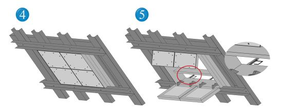
Legen Sie die Jumbo-Deckenklappe auf die Montagehilfe und überprüfen Sie die richtige Lage der Klappe in der Öffnung.
