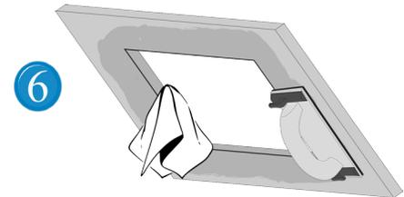
Drücken Sie den Rahmen von oben an die Deckenplatte. Nun verschrauben Sie den äußeren Einbaurahmen mit Bohrkopfschrauben im Abstand von max. 13 cm an der Gipskartondecke.
