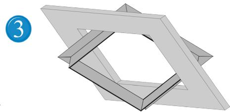
Bitte zeichnen Sie mithilfe eines rechten Winkels den Einbau-Ausschnitt an der Gipskartondecke an. (Bestellmaß + 5 mm)
