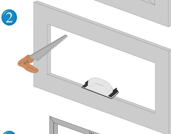
Schneiden Sie den Einbau-Ausschnitt nun aus. (Stichsäge, Fuchsschwanz...)
