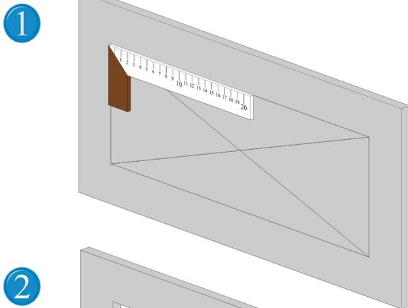
Bitte zeichnen Sie mithilfe eines rechten Winkels den Einbau-Ausschnitt an der Gipskartonwand an.
