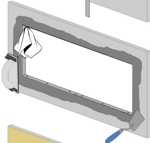
Spachteln Sie jetzt bei beiden Rahmen den umlaufenden Anschluss an die Gipskartonbeplankung inkl. der Schrauben. Putzen Sie bitte die beiden Alu-Rahmen der Revisionsklappe sauber ab. Dies ist besonders wichtig, damit die Funktion der Revisionsklappe nicht beeinträchtigt wird. Schleifen Sie nach dem Trocknen Unebenheiten ab.
