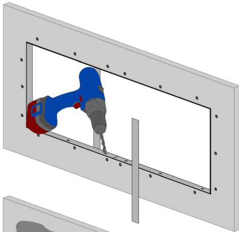
Bohren Sie mit einem Bohrer  $\varnothing$  6 mm durch die vorgebohrten Löcher im Rahmen ca. 1 cm tief in die Gipskartonwand, damit der Alustift aufgenommen werden kann. Entfernen Sie die Abstandshalter indem Sie die rückseitigen Schrauben herausdrehen.
