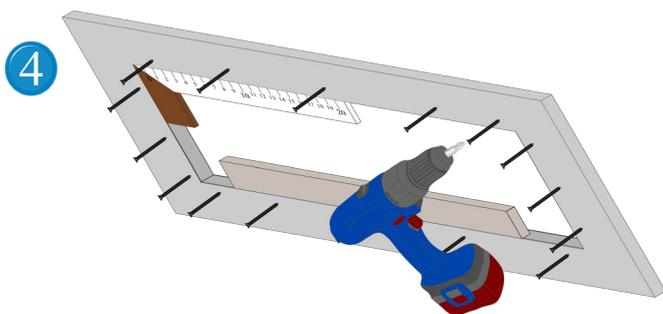
Drücken Sie den Rahmen von hinten an die Deckenplatte.
