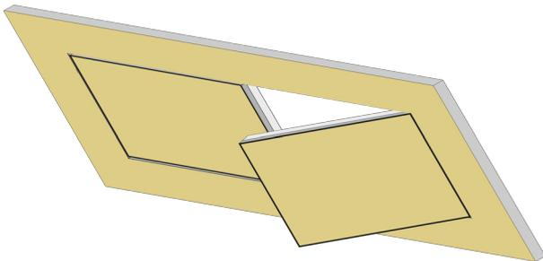
Hängen Sie aus Sicherheitsgründen die Fangsicherung ein und schließen Sie die Revisionsklappe. Bitte beachten Sie dies auch nach jedem Öffnen der Klappe.
