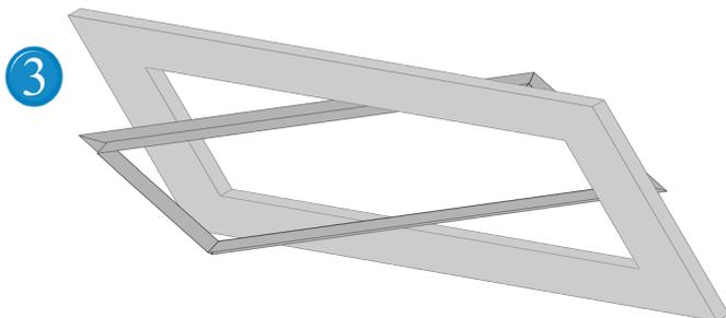
Nehmen Sie die Türblätter aus dem Außenrahmen, führen Sie diesen durch die Öffnung in den Deckenhohlraum und legen Sie ihn in den Ausschnitt.
