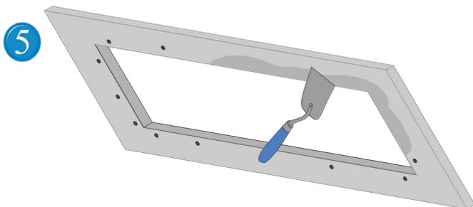
Spachteln Sie jetzt bei beiden Rahmen den umlaufenden Anschluss an die Gipskartonbeplankung inkl. der Schrauben.
