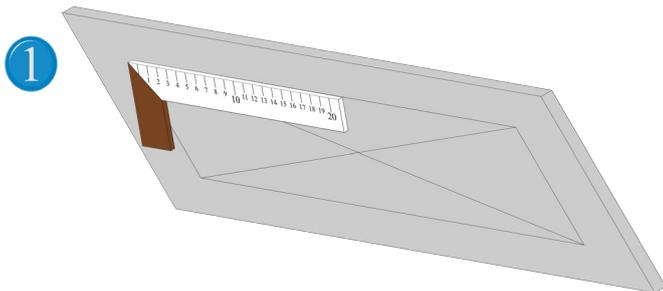
Bitte zeichnen Sie mithilfe eines rechten Winkels den Einbau-Ausschnitt an der Gipskartondecke an.
