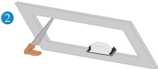
Schneiden Sie den Einbau-Ausschnitt nun aus. (Stichsäge, Fuchsschwanz...)
