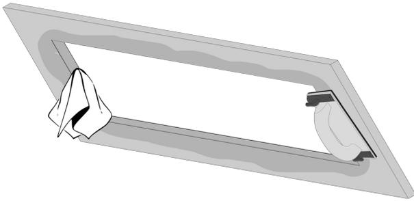
Putzen Sie bitte die beiden Alu-Rahmen der Revisionsklappe sauber ab. Dies ist besonders wichtig, damit die Funktion der Revisionsklappe nicht beeinträchtigt wird. Schleifen Sie nach dem Trocknen Unebenheiten ab.
