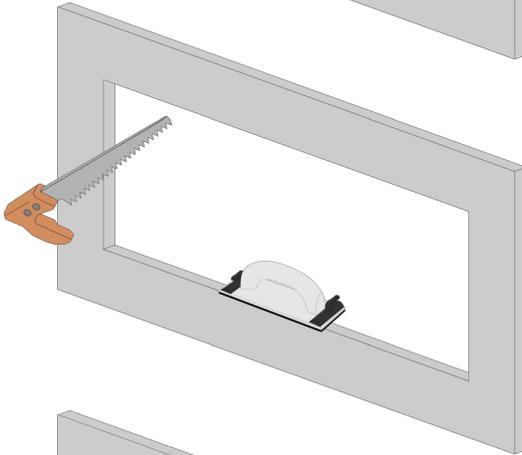
Schneiden Sie den Einbau-Ausschnitt nun aus. (Stichsäge, Fuchsschwanz...)
