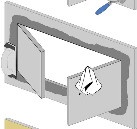
Putzen Sie bitte die beiden Alu-Rahmen der Revisionsklappe sauber ab. Dies ist besonders wichtig, damit die Funktion der Revisionsklappe nicht beeinträchtigt wird. Schleifen Sie nach dem Trocknen Unebenheiten ab.
