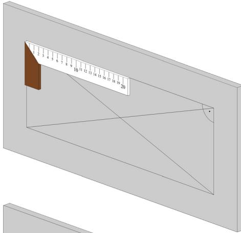
Bitte zeichnen Sie mithilfe eines rechten Winkels den Einbau-Ausschnitt an der Gipskartonwand an.
