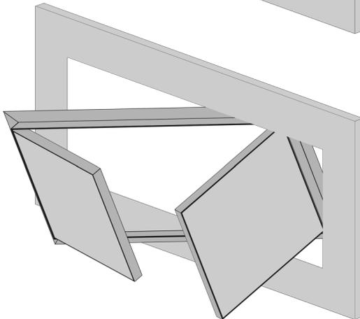
Öffnen Sie die Klappenflügel und führen Sie die Revisionsklappe durch die Öffnung in den Wandhohlraum.
