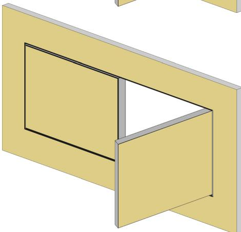
Hängen Sie aus Sicherheitsgründen die Fangsicherung ein und schließen Sie die Revisionsklappe. Bitte beachten Sie dies auch nach jedem Öffnen der Klappe.
