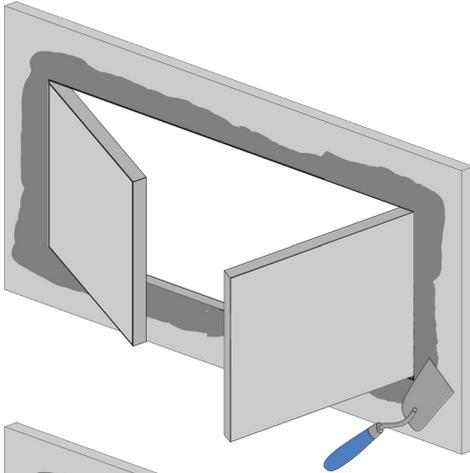
Spachteln Sie jetzt bei beiden Rahmen den umlaufenden Anschluss an die Gipskartonbeplankung inkl. der Schrauben.
